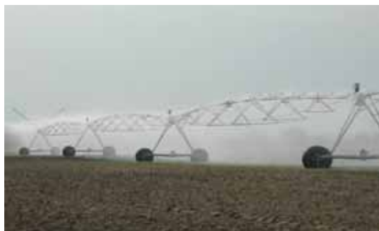
Дождевальная машина ДМУ "Фрегат-Н" кругового действия с модернизированным дождевым поясом для работы на пониженном напоре
