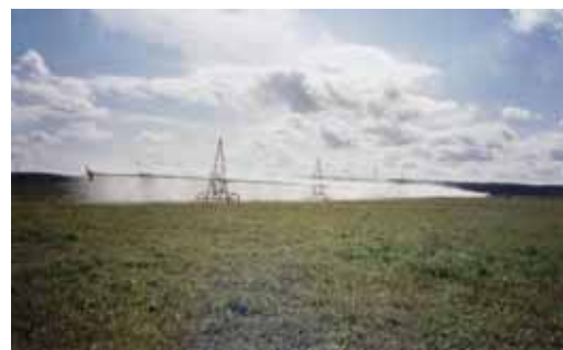
Дождевальная электрифицированная машина кругового действия «Кубань-ЛК 1» с усовершенствованным дождевым поясом
